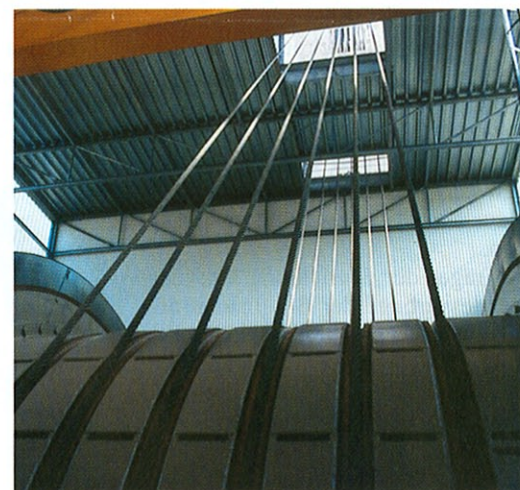
1987 eine Weltneuheit: Sechs-Seil-Fördermaschine mit Drehstromsynchron-Motor in einer Einheit.
