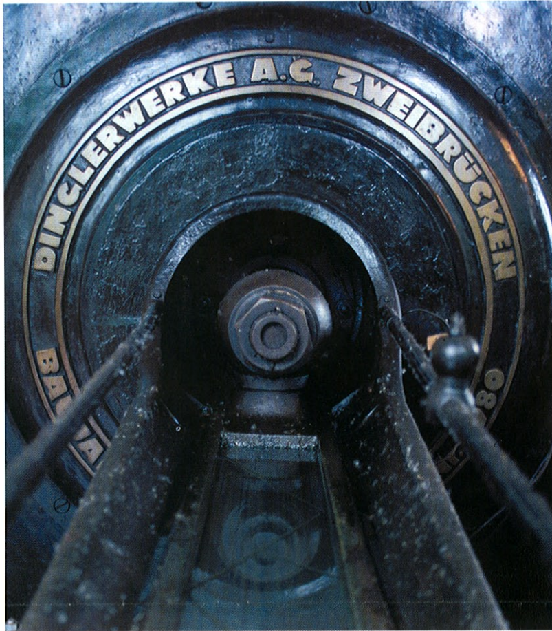
Detail von der Dampfmaschine der westlichen Förderung. Das gewaltige Förderaggregat der Zweibrücker Dinglerwerke stammt aus dem Jahre 1936.
