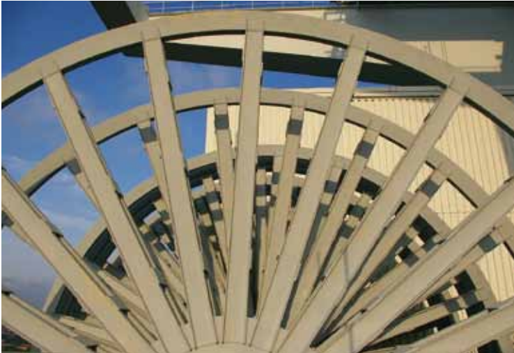
Quierschied-Göttelborn: Seilscheibenbühne in 74,3 Meter Höhe am Schacht Göttelborn IV.
