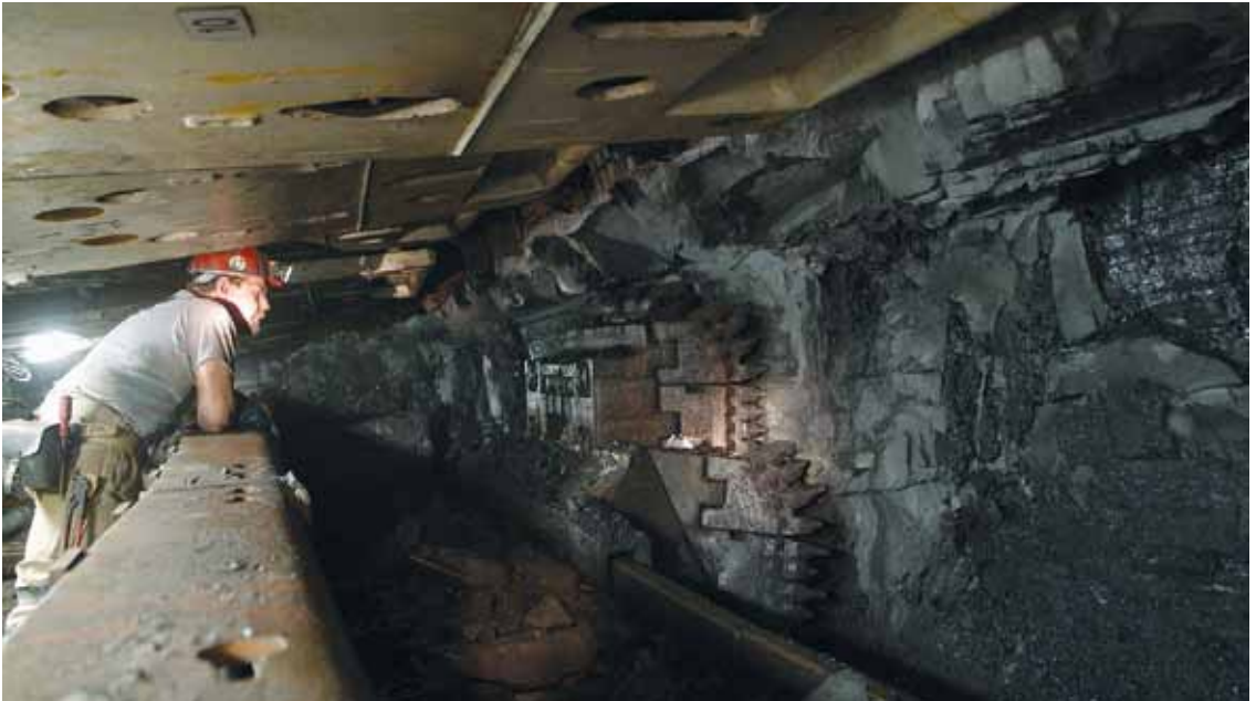
Kohlehobel im Einsatz – neue Technik auf dem Bergwerk Saar (2011).
